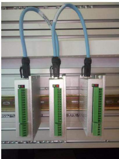
扩展模块连接无需设定地址，其实际在整个网络的位置由在 KincoBulider 软件硬件配置时确定模块顺序决定。如下图所示，硬件配置中 KS123-14DR 在 CPU 模块之后的第一个位置，KS133-06IV 在 CPU 模块的第二个位置（也就是紧随 KS123-14DR 之后的位置）。
